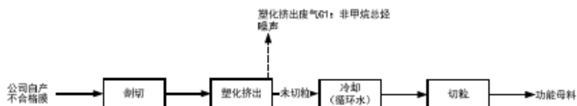
图 6 回收膜生产功能母料线生产工艺流程及产污环节图
